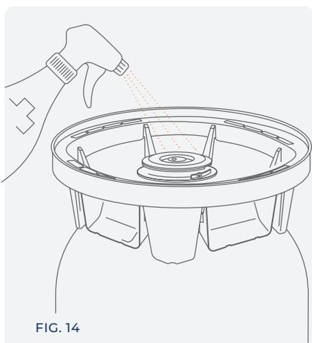
Rimuovere eventuali residui di prodotto con acqua, sanificare la parte esterna della valvola come indicato nella sezione "Istruzioni per la sanificazione" ed asciugarla.
