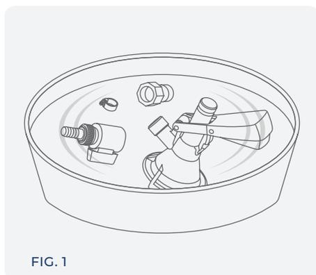
Smontare il kit di riempimento PolyKeg® e sanificare le parti nella figura e nella sezione "Istruzioni per la sanificazione".
