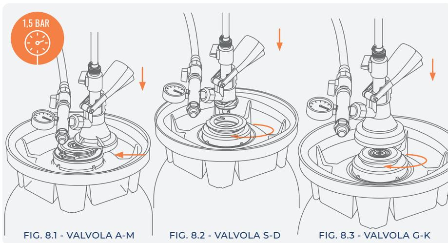
Collegare correttamente la testa di riempimento alla valvola, abbassare la leva e verificare la pressione interna del fusto.
